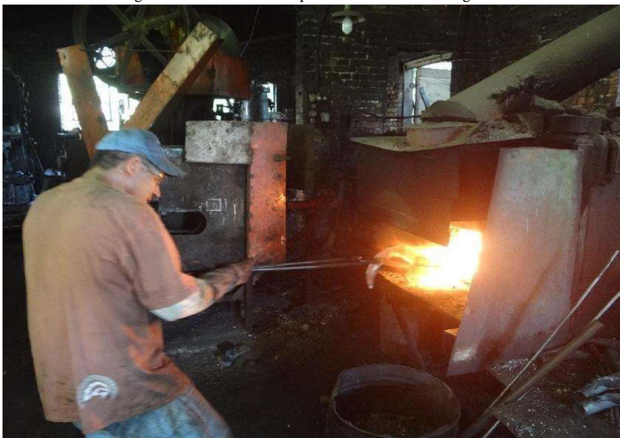
Figura 9 – Processo de têmpera dado à ferramenta agrícola.
