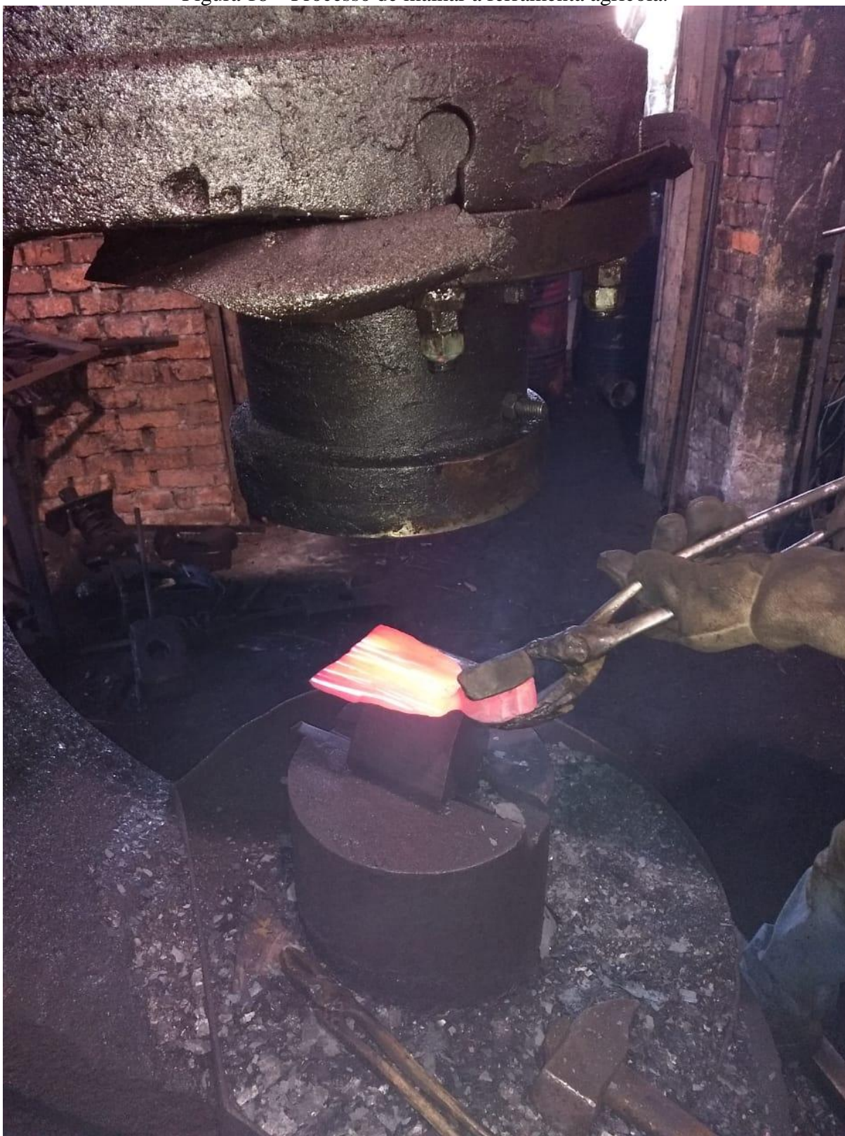
Figura 18 – Processo de malhar a ferramenta agrícola.
